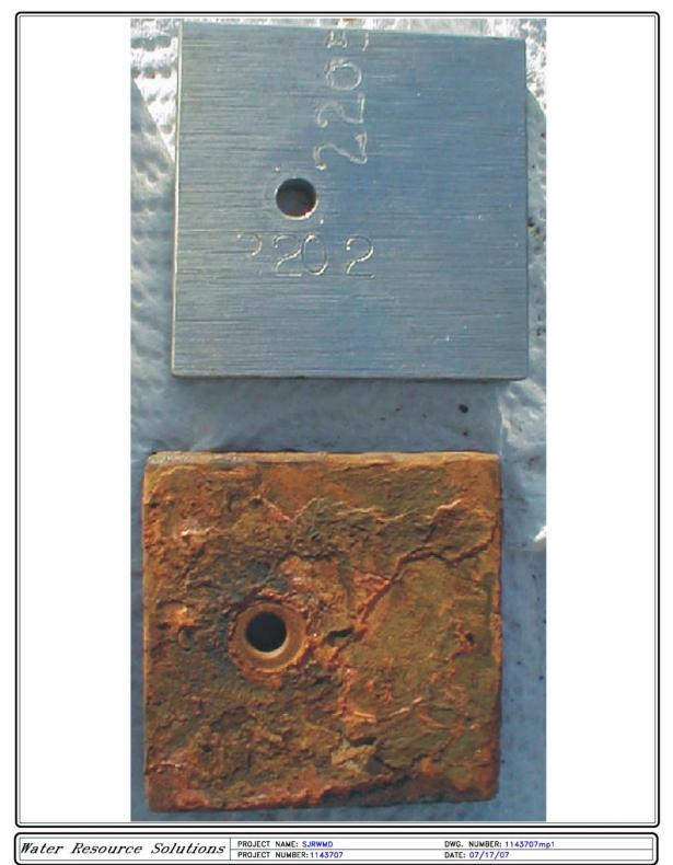
FIGURE 2. COMPARISON OF 2205 (ALSO MARKED 2202) COUPON AND MILD STEEL COUPON CORROSION AFTER 92 DAYS IN IW-1 INJECTION STREAM.
